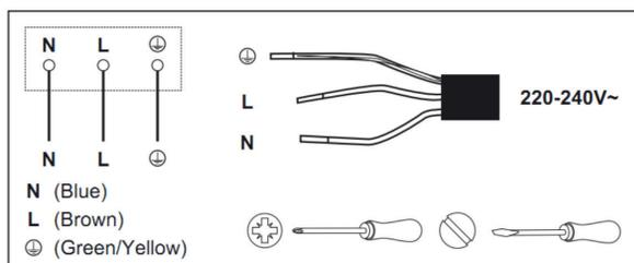
Для этого прибора требуется 32-амперный миниатюрный автоматический выключатель.
